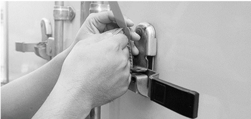
Son dispositivos que conectan o restringen la carga a la estructura del vehículo. Un buen amarre es una combinación de estos dispositivos conectados a un punto de anclaje. Los amarres están unidos a la carga o pasan a través de ella. La fuerza adicional hacia abajo crea la fricción que restringe la carga.
