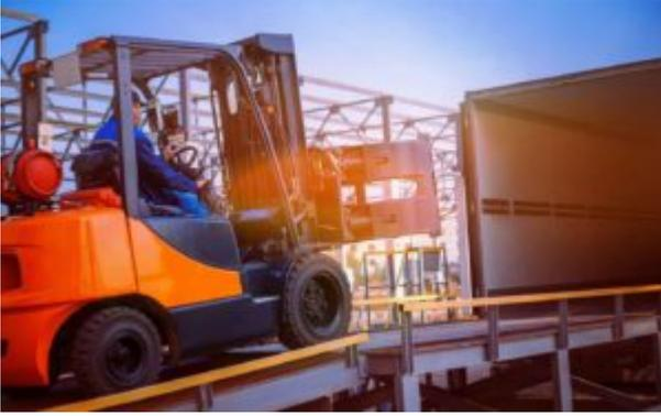
La carga y descarga de carretillas elevadoras y otros camiones están sujetas a requisitos de seguridad específicos que tienen por objeto garantizar la estabilidad de las cargas y evitar daños a los operadores y a otras personas que se encuentren cerca.
